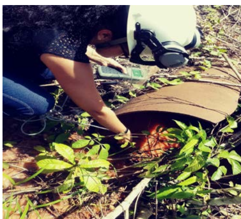
Figura 3: Amostragem e medições in loco na saída do lançamento de efluentes.
