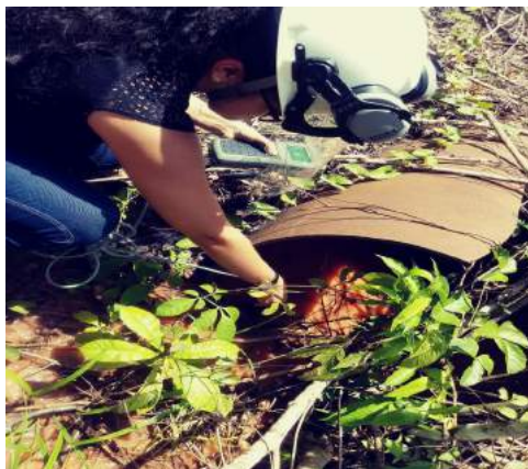
Figura 9: Amostragem e medições in loco na saída do lançamento de efluentes.
